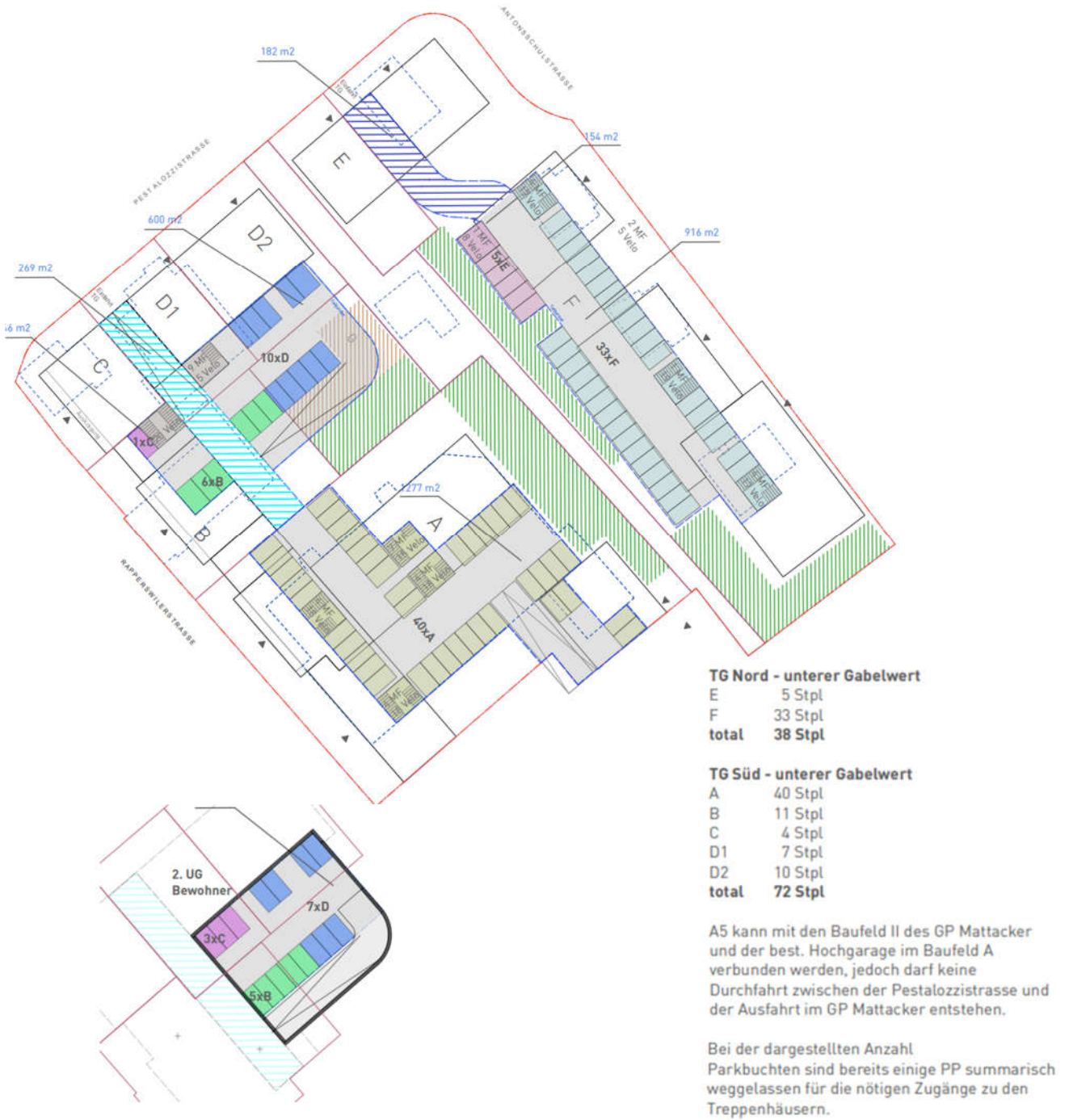
Abbildung 19 Tiefgaragenkonzept und Parkplatzberechnung gem. Parkplatzverordnung
